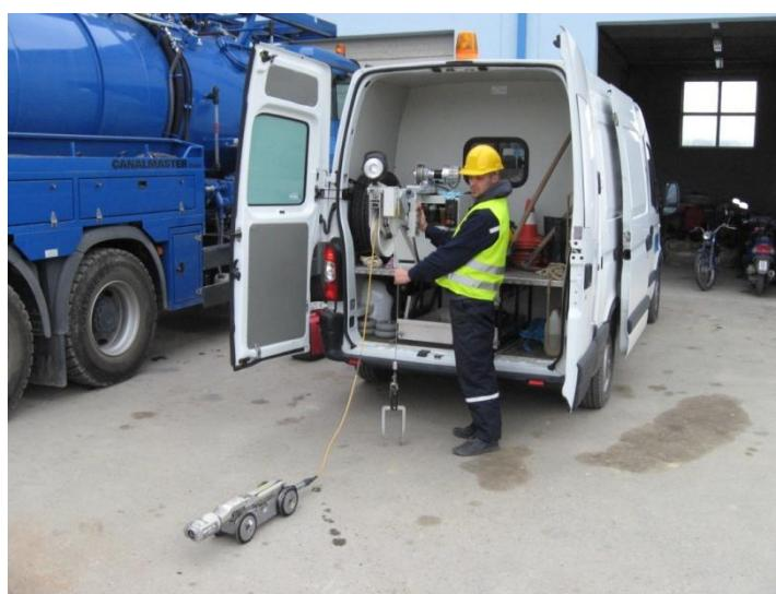
**Oprema za CCTV inspekciju kanalizacijskih cjevovoda**
